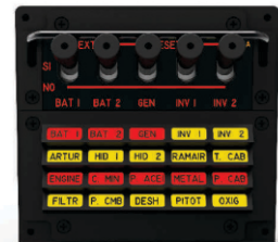
Panel de Alarmas Piloto
